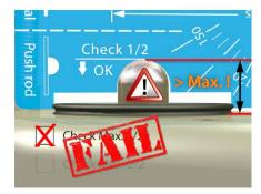
Le test échoue si le calibre ne repose pas à plat sur le cylindre du fait d'un contact avec le poussoir.
