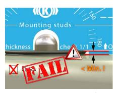
La hauteur du joint ne doit pas être inférieure à 3 mm. Si la hauteur du joint se situe en-dessous de la ligne "min. thickness check 1/1", c'est que le test a échoué.
