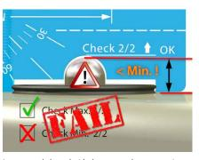
Le test a échoué si la hauteur du poussoir est en-dessous de la ligne "OK".
